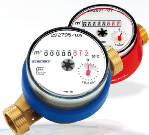
GSD-8P - Wodomierz standardowy z pierścieniem zaciskowym, co pozwala wyeliminować plombę ołowianą
